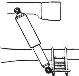
**IMPORTANTE:** En algunos casos, al instalar amortiguadores o unidades estabilizadoras delanteras pudiera ser necesario agrandar ligeramente el agujero en el brazo inferior de la suspensión, para permitir el pasaje de la unidad. Esto se puede lograr roscando la orilla interna del agujero, limando o rectificando. Agrande los agujeros sólo lo suficiente para permitir el pase de la unidad.
