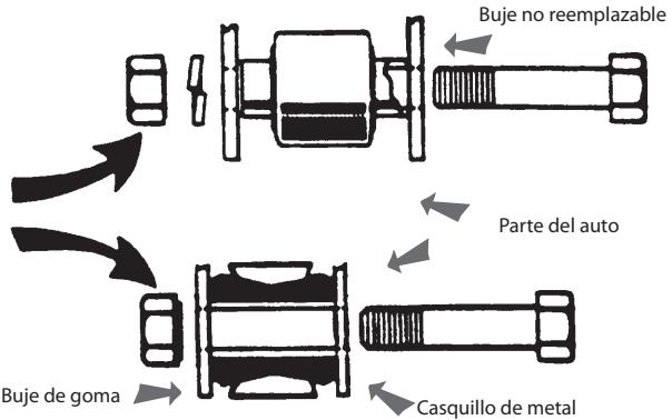
ASEGÚRESE QUE EL MANGUITO DE METAL ESTÁ AISLADO EN EL BUJE DE GOMA, VUELVA A EMPLEAR EL PERNO, LA TUERCA Y LA ARANDELA DE SEGURIDAD DE MONTAJE.
