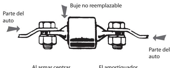
LOS EXTREMOS ACHATADOS DEL PASADOR ESTÁN DISEÑADOS PARA CALZAR EN ESCUADRA CONTRA LA PLACA DE MONTAJE A LA ALTURA NORMAL DEL AUTO. AL INSTALAR, SI LAS PARTES ACHATADAS NO ESTÁN EN ESCUADRA CON LA PLACA, GIRE EL AMORTIGUADOR MEDIA VUELTA PARA MEJOR ALINEACIÓN.
